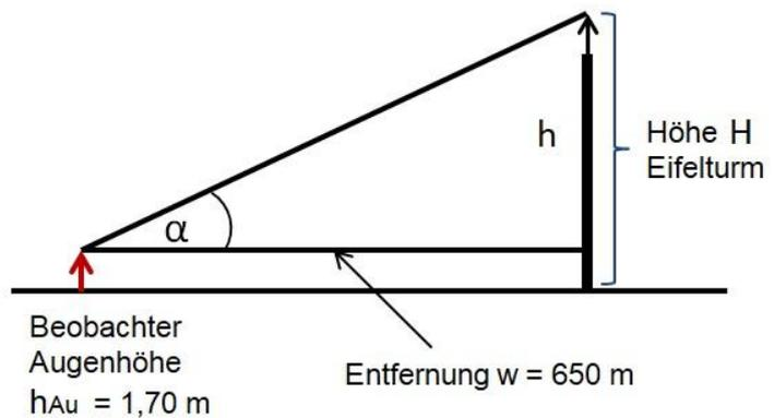
Zunächst wird vom Winkel  $\alpha$  aus die gegenüberliegende Kathete  $h$  berechnet mit:
