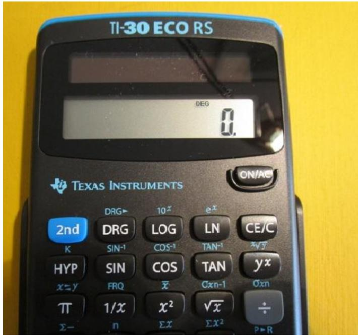
Zu beachten ist an diesem Rechner, dass nach dem Einschalten im Display automatisch DEG (Winkelgrade) angezeigt wird. Die Winkelingabe erfolgt in Grad:
