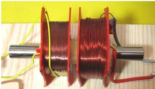
Es soll untersucht werden, was passiert, wenn im Bild in der linken Spule ein Gleichstrom eingeschaltet wird und gleichzeitig der Spannungsverlauf an der rechten Spule gemessen wird. Das Schaltbild zeigt das folgende Bild:
