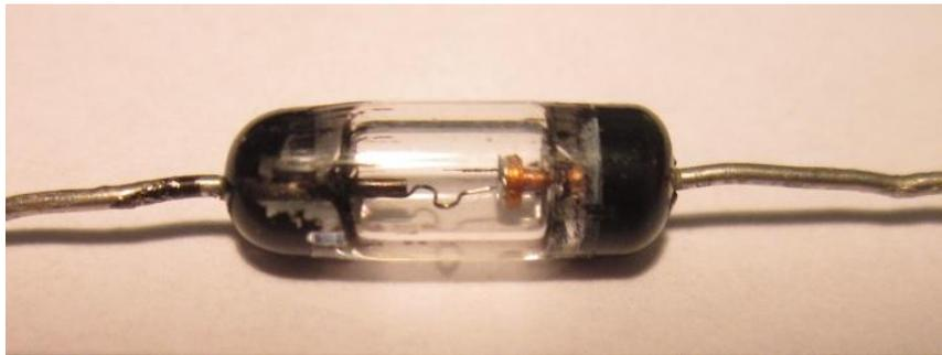
Mit der niedrigen Durchlassspannung der OA 81 von nur 0,5 Volt war es damals möglich, mit einer Detektorschaltung Radiosendungen auf Mittelwelle zu empfangen. Die Schaltung eines Detektors mit der OA 81 ist ganz einfach:
