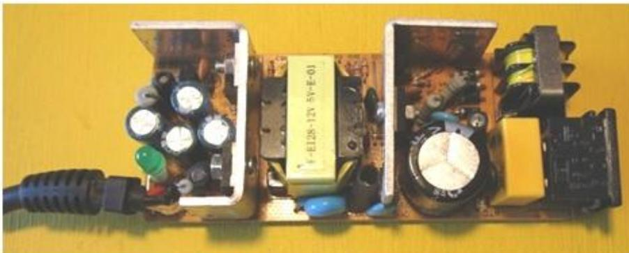
Die Wechselspannung am Eingang liegt im Bereich von 100 bis 240 V~ mit einem Strom von maximal 1,5 A.
