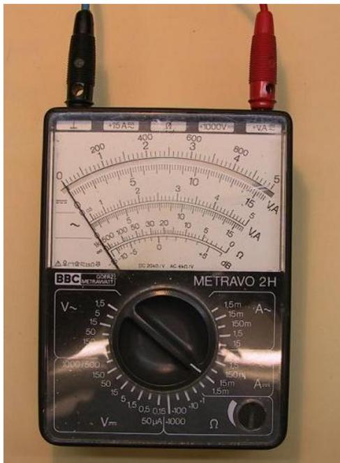
Der Messbereichschalter zeigt auf den Bereich  $0 \dots 15 \text{ mA}$  und Gleichstrom (A =).
